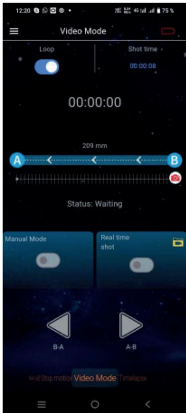
В режиме **Video Mode** можно перемещать камеру для видеосъемки от А к В и обратно в ручном (**Manual mode On**) или циклическом (**Manual mode Off**) режимах.
