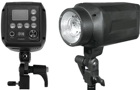
Установите вспышку на стойку и закрепите фиксатором. Установите в патрон лампу пилотного света. Подключите вспышку кабелем к розетке электросети 220 В 50 Гц и включите питание клавишей POWER. Когда услышите сигнал зуммера, вспышка готова к работе.
